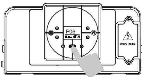
6. Нажмите кнопки « $\oplus$ » и « $\ominus$ » (установка температуры бытового горячего водоснабжения),
