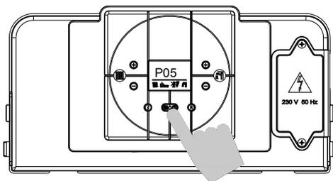
6. Нажмите кнопки « $\oplus$ » и « $\ominus$ » (установка температуры бытового горячего водоснабжения)
