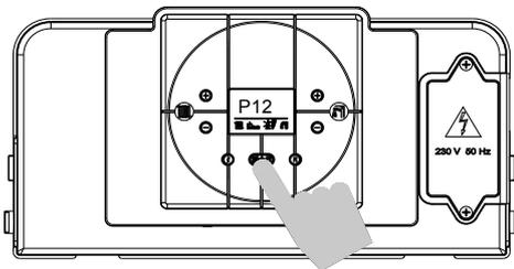
**ПАРАМЕТР P12 — УСТАНОВКА КРИВОЙ КЛИМАТИЧЕСКОЙ КОМПЕНСАЦИИ (только в установках с датчиком наружной температуры)**
