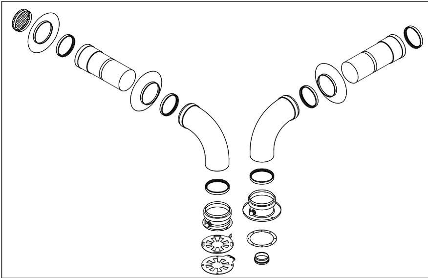
Отводит отработанные газы и производит забор топочного воздуха для горения через два отдельных канала диам. 80 мм.
