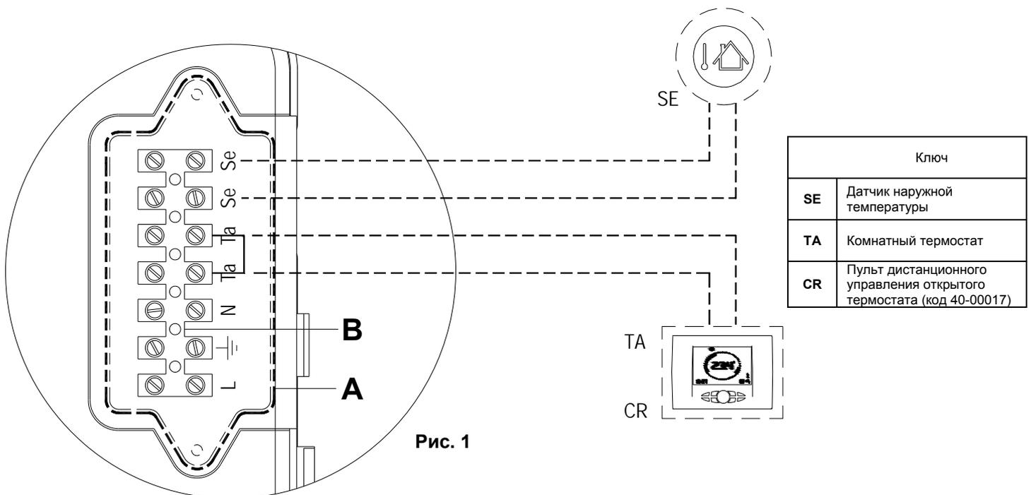
В случае одновременной установки датчика наружной температуры и пульта дистанционного управления печатная плата отправляет значение наружной температуры только в пульт дистанционного управления, не используя его для модуляции.
