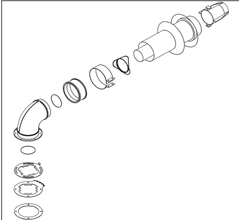
*Отводит отработанные газы и производит забор топочного воздуха для горения через два коаксиальных канала. Внешний канал производит забор топочного воздуха для горения, а внутренний канал отводит отработанные газы.*
