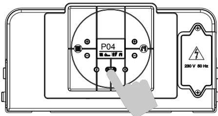
**ПАРАМЕТР P04 — ТАЙМЕР В КОНТУРЕ ЦЕНТРАЛЬНОГО ОТОПЛЕНИЯ**
