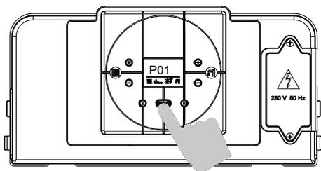
5. Нажмите и отпустите кнопку выбора режима «
