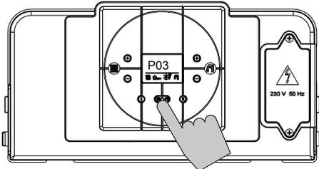
**ПАРАМЕТР P03 — ФУНКЦИЯ ПРЕДОТВРАЩЕНИЯ ГИДРАВЛИЧЕСКОГО УДАРА**
