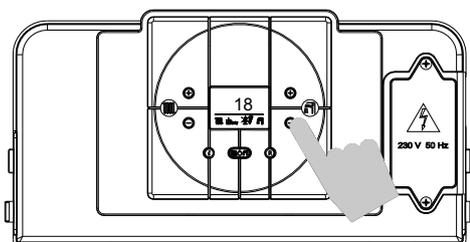
**ПАРАМЕТР P06 — ЗАДЕРЖКА ПЕРЕКЛЮЧЕНИЯ НАСОСА АККУМУЛИРУЮЩЕГО ЦИЛИНДРА/БЫТОВОГО ГОРЯЧЕГО ВОДОСНАБЖЕНИЯ (Неприменимо к быстродействующим котлам (с двухконтурным теплообменником))**
