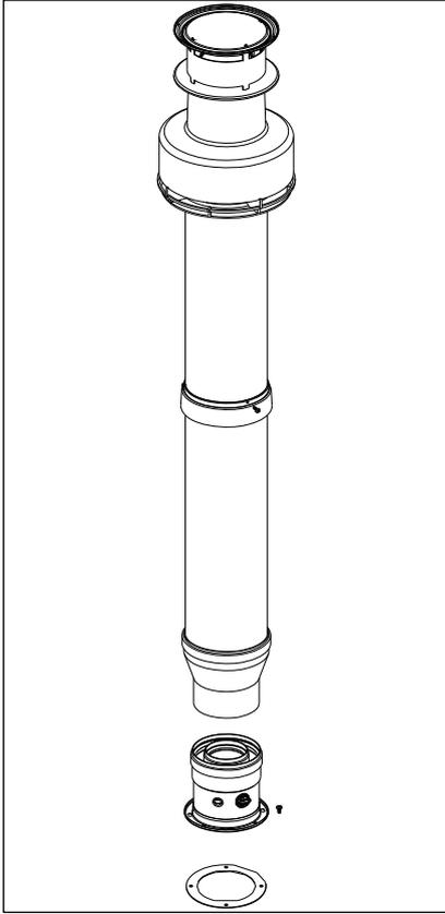
Отводит отработанные газы и производит забор топочного воздуха для горения на уровне крыши через два коаксиальных канала. Внешний канал диам. 125 мм производит забор топочного воздуха для горения, а канал диам. 80 мм отводит отработанные газы.
