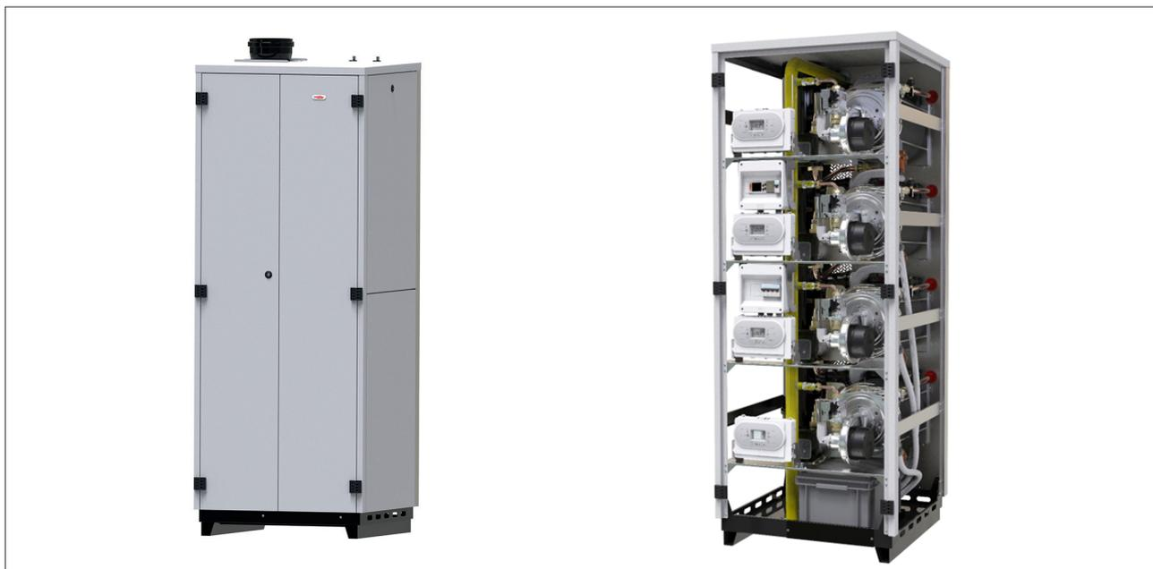
Radiant R1KG 180 и R1KG 240 - это высокоэффективные напольные газовые котлы с плавной регулируемой мощностью. Теплообменники котла сделаны из нержавеющей стали, состоящие соответственно из трех или четырехпервичных теплообменников мощностью 60 кВт каждый.
